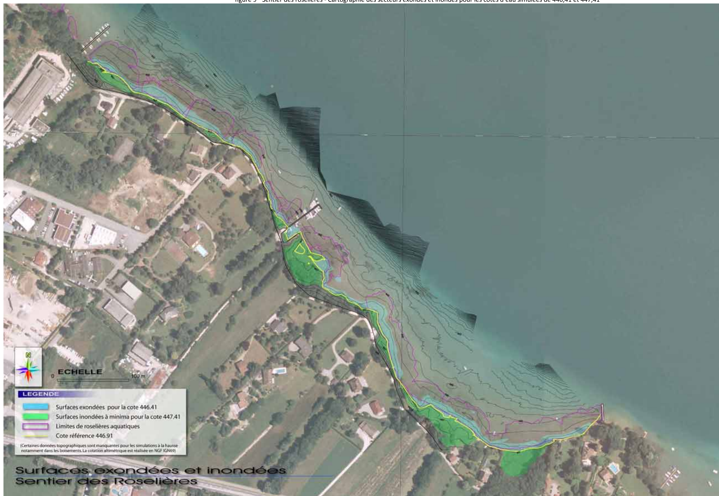
figure 9 Sentier des roselières - Cartographie des secteurs exondés et inondés pour les cotes d'eau simulées de 446,41 et 447,41
