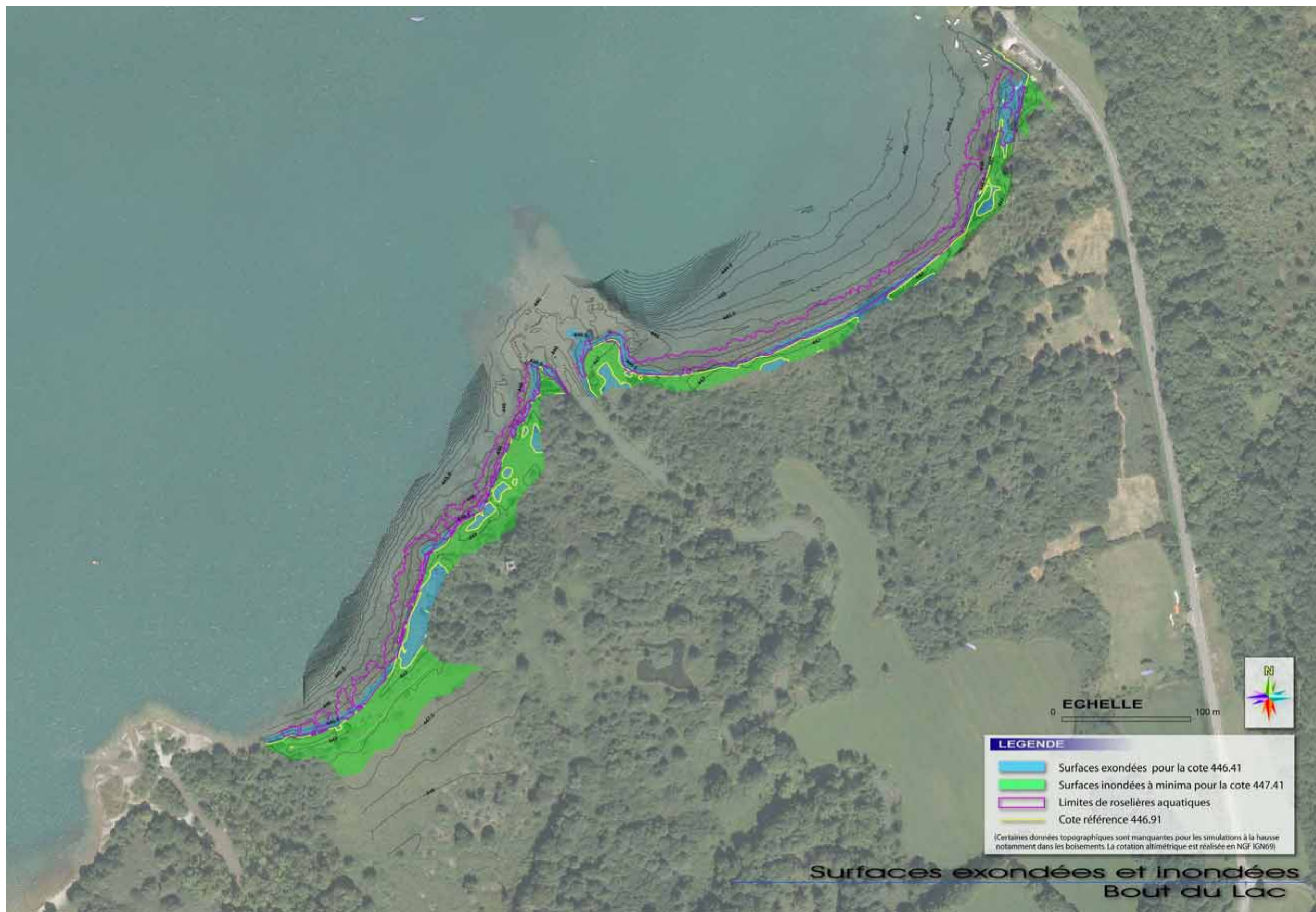
figure 10 Bout du Lac - Cartographie des secteurs exondés et inondés pour les cotes d'eau simulées de 446,41 et 447,41
