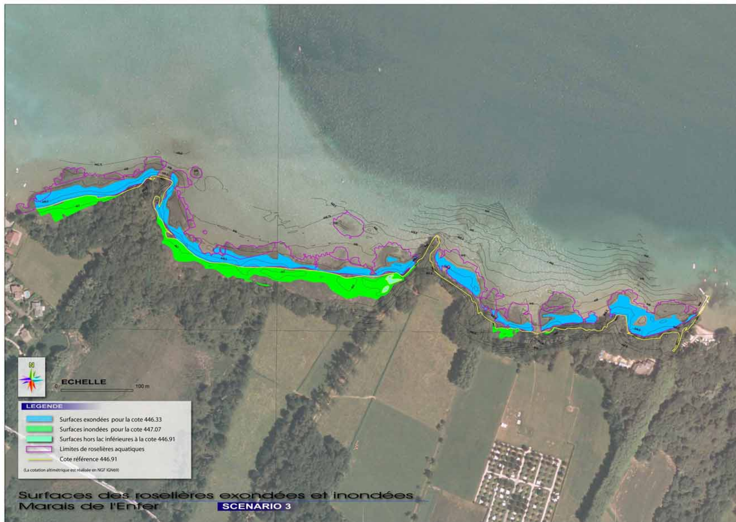
figure 15 Marais de L'enfer - Cartographie des secteurs exondés et inondés pour les cotes d'eau extrême du scénario 3
