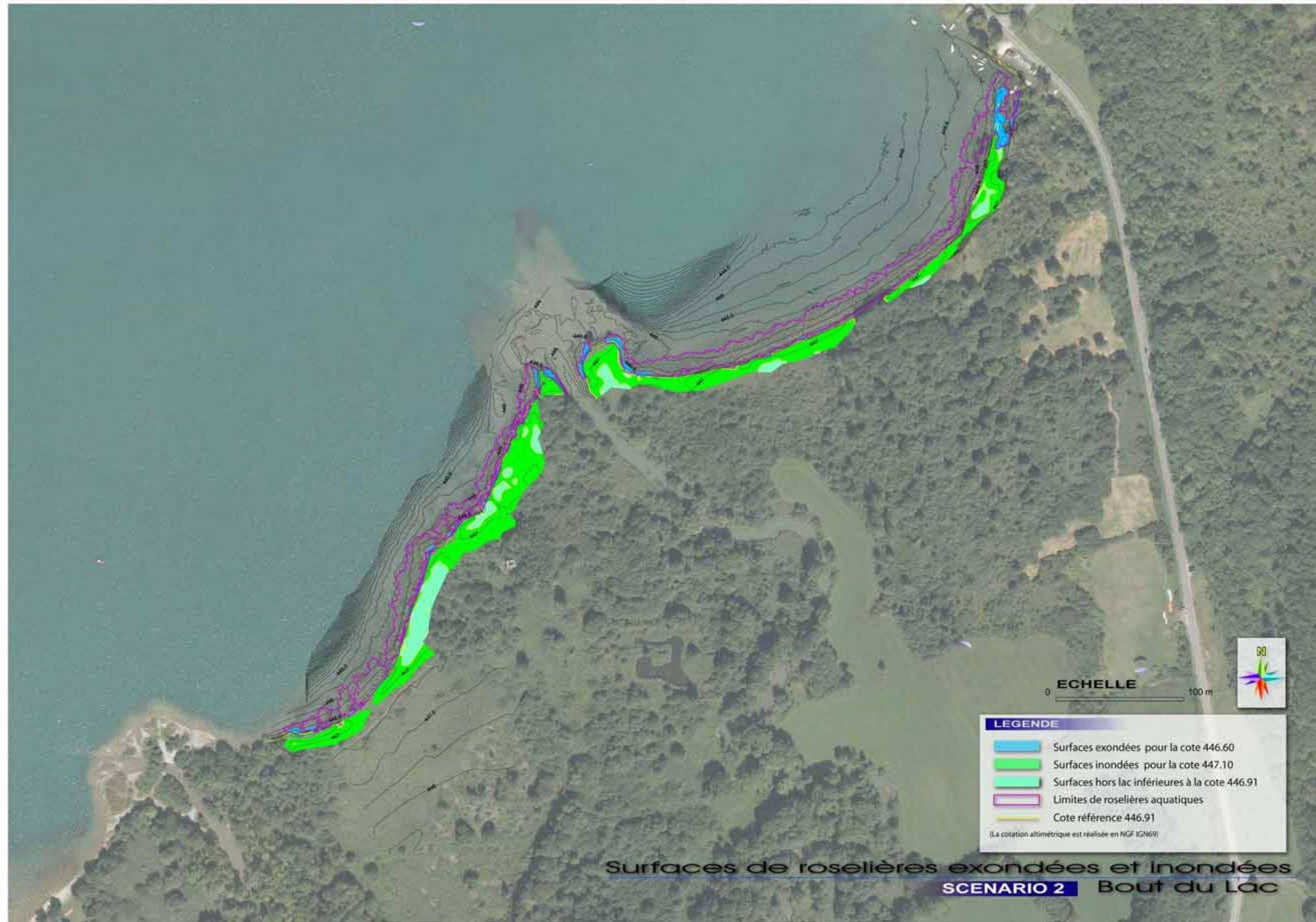
figure 14 Bout du Lac - Cartographie des secteurs exondés et inondés pour les cotes d'eau extrême du scénario 2
